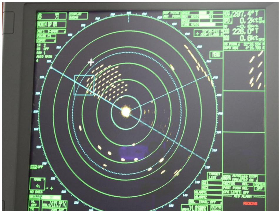
Figuur 13 - Opname van de S-Band radar waarbij het doelschip op korte afstand het windpark passeert.
