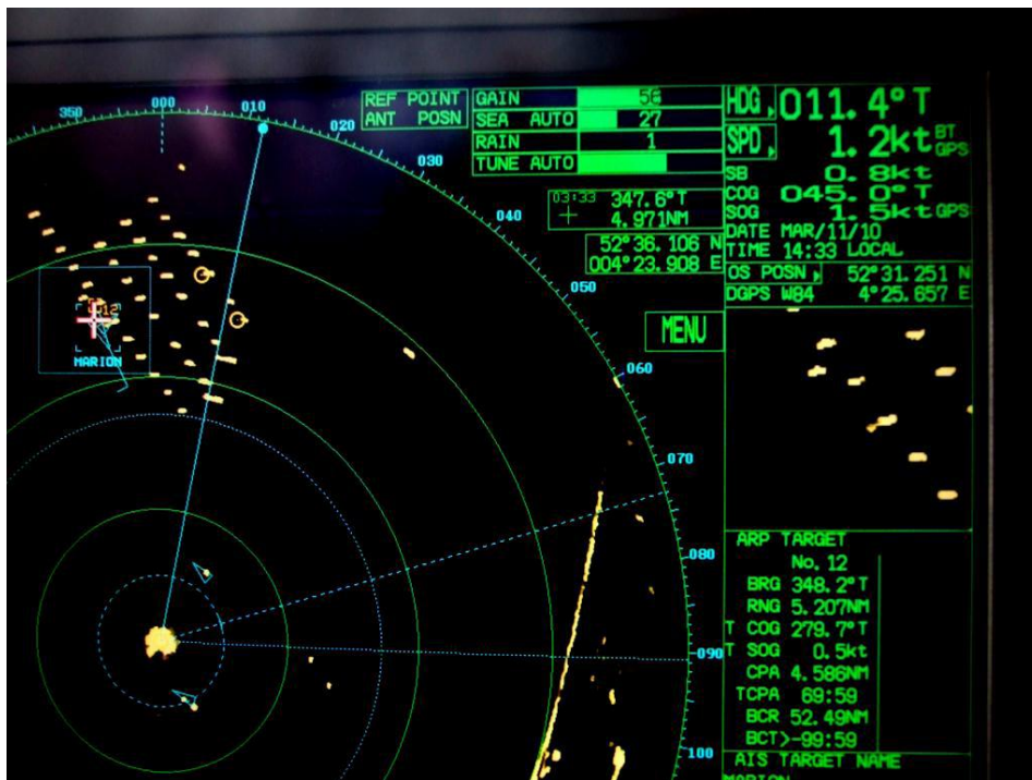
Figuur 14 - Opname van de X-Band radar gedurende het veldexperiment bij OWEZ
