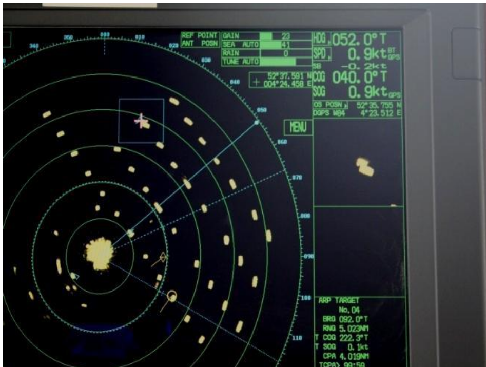
Figuur 10 - Opname van S-Band radar waarop doelschip samenvloeit met windturbine
