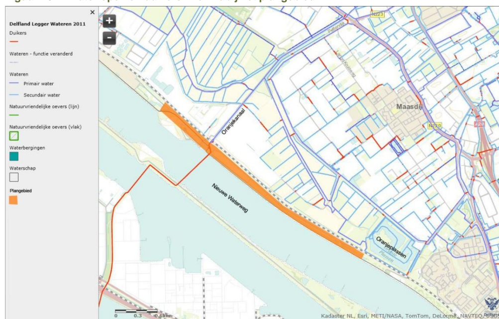
Figuur 10.7: Waterlopen en duikers in en nabij het plangebied
